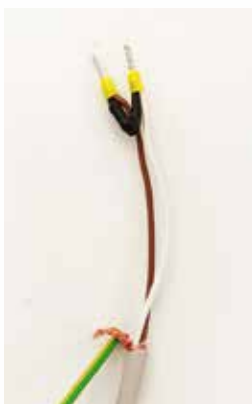
⑥ Connessione calza giallo-verde
