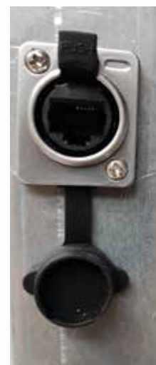
⑤ Particolare connessione per PGD o aggiornamento SW
