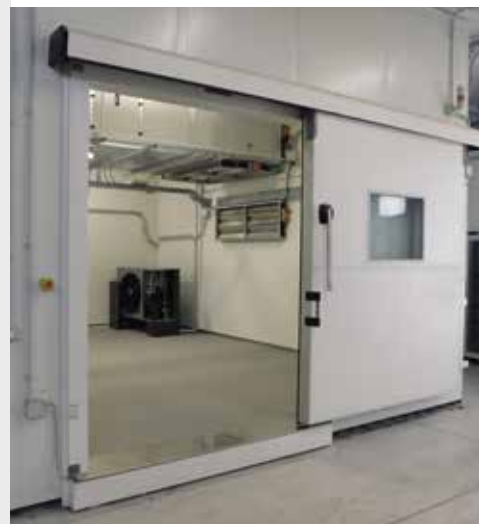
Die Klimakammer am neuen Standort, wo die KITAs getestet werden.
